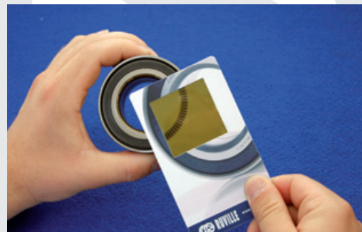
Esempio di applicazione della detector-card su di un cuscinetto sensore con riconoscimento dell'anello generatore di impulsi nella figura sotto
